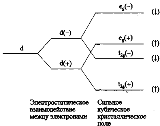
Рис. 1.12. Расщепление уровней d-оболочки в результате электростатического взаимодействия между электронами и действия сильного кристаллического поля (знаками «+» и «-» отмечены противоположные ориентации спинов)
